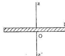
Un plateau D est constitué par un disque circulaire, de rayon  $R = 0,5$  m, de masse  $m = 10$  kg, homogène et d'épaisseur constante ; il est mobile sans frottement autour de son axe de révolution vertical Oz. Il est soumis à un couple de rappel, produit par un ressort spiral, proportionnel à l'angle de rotation  $\alpha$  à partir de sa position d'équilibre.  $N = -C\alpha$  ; C constante de torsion du ressort spiral.
